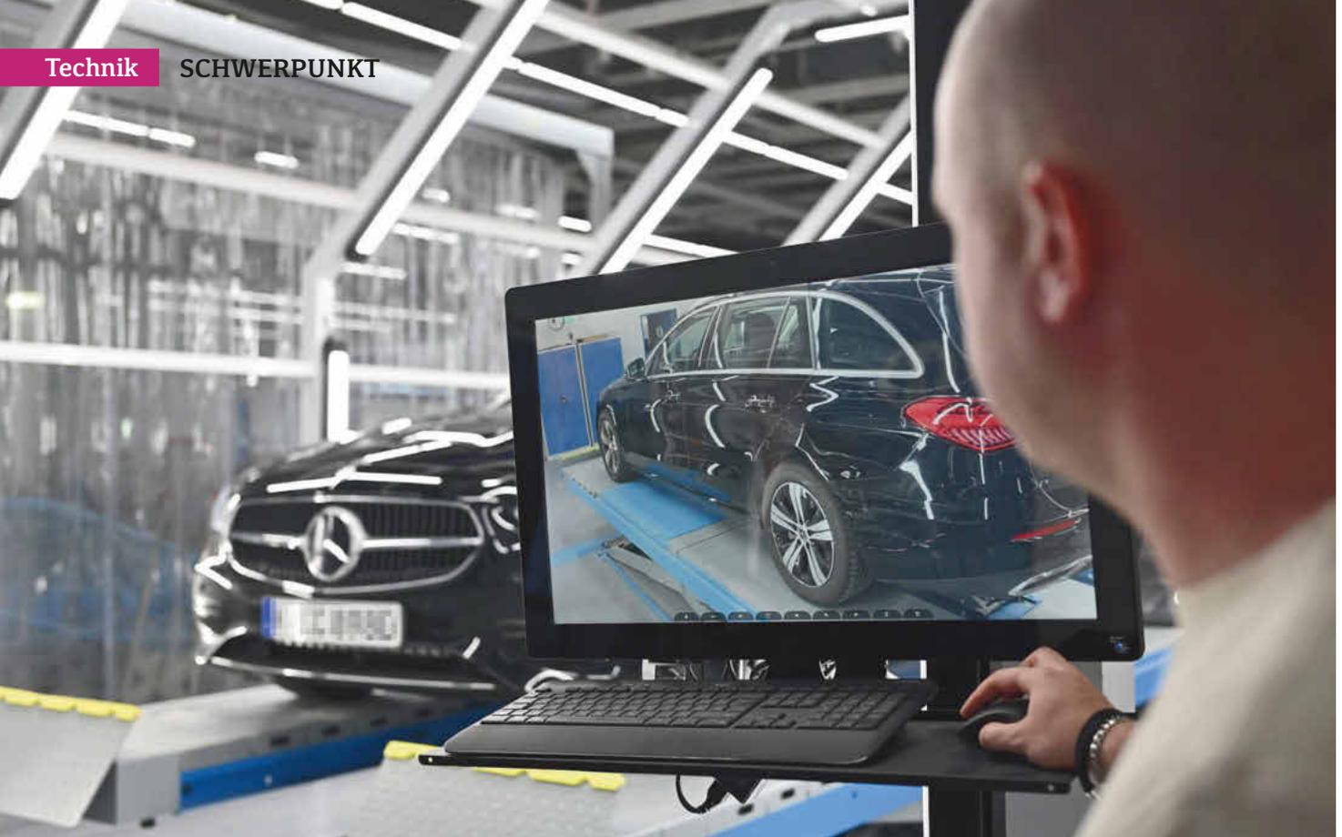
Wer an Leasingfahrzeugen arbeitet, muss diese korrekt bewerten können. Im LPS-Premium-Center in Neuss sorgen ein LED-Lichttunnel und sieben Kameras für die optimale Schadenaufnahme. (Foto: A. Hauser)
